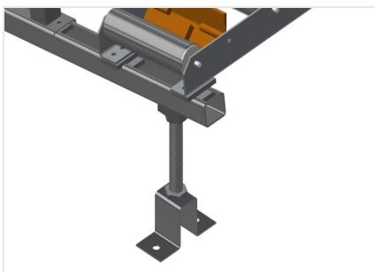
**Réglage en hauteur du convoyeur à rouleaux**
