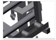
Barre de serrage Centrage au milieu pneumatique. Précision grâce au pressage parallèle des barres de serrage
