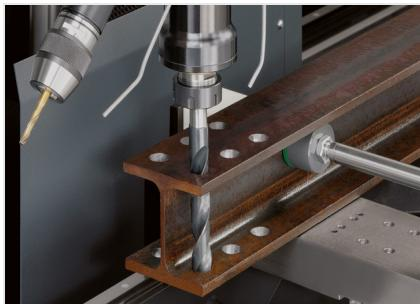
**Centre d'usinage de barres SBZ 130 eluCam**
