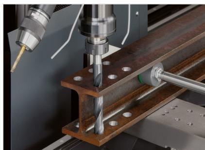
**Centre d'usinage de barres SBZ 130 eluCam**
