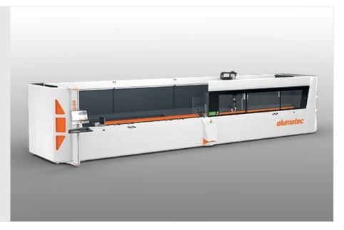
Gagner du temps, économiser de l'espace, réduire les coûts : Le centre d'usinage de barres SBZ 125/85 est une machine à cabine encapsulée de huit mètres de longueur utile et cinq axes, qui peut remplacer deux machines plus petites grâce à un mode pendulaire dynamique. Lors du développement du modèle à succès SBZ 122, elumatec a utilisé le retour de ses clients pour optimiser l'ergonomie, l'accès et les délais de rééquipement.
