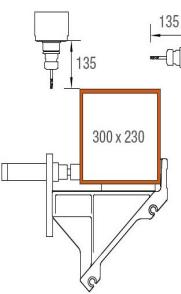
**Zone d'usinage axes Y et Z**
