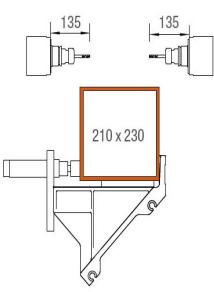
**Zone d'usinage axes Y et Z**
