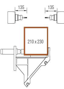
**Zone d'usinage axes Y et Z**
