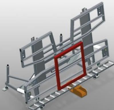
Table d'assemblage pour le montage vertical et horizontal
