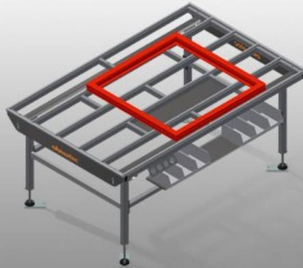
Mesa de trabajo modular para una línea de fabricación (módulo básico)
