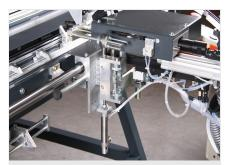
Atornillador con boquilla de tolva de carga manual
