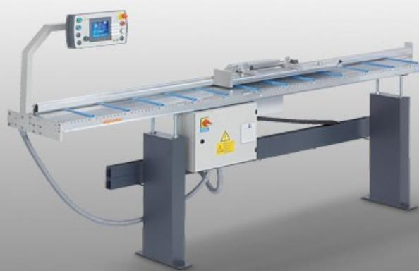
Sistema de topes y medición con ajuste automático de la longitud de corte y control de posicionamiento E 355
