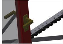
**Röllchenbahn**Drei Röllchenbahnen mit Gummi-Rollen,Durchmesser 50 mm
