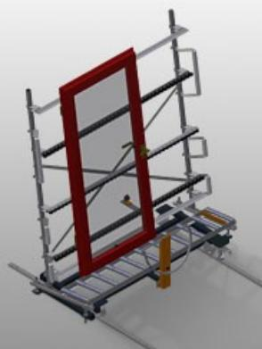
Rollenbahn vertikal für den Transport von Fensterelementen
