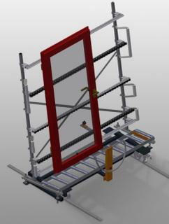
Rollenbahn vertikal für den Transport von Fensterelementen
