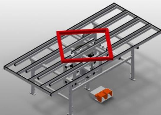
Hebe-Drehtisch für Montage und Dichtungseinzug
