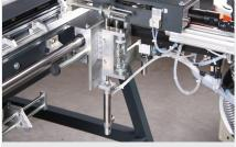
Schraubeinheit fahrbar mit pneumatischer Höhenverstellung. Handeinwurftrichter für zweite Schraubenlänge. Automatische Tiefenabschaltung
