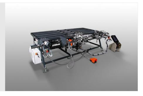
Flügelanschlagzentrum für die Beschlagmontage an Kunststoff- und Aluminium-Fensterflügeln
