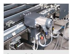
Pneumatische Höhenverstellung für Schlosskasten
