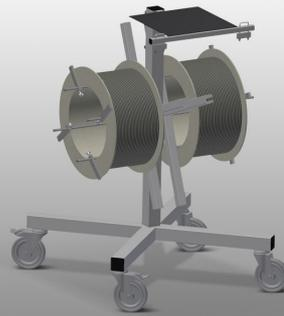
Dichtungswagen für die Aufnahme von Dichtungsrollen
