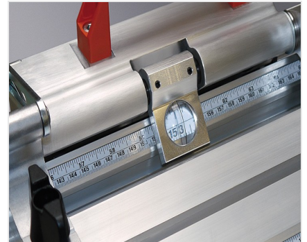
Dorazový a měřicí systém AMS 200
